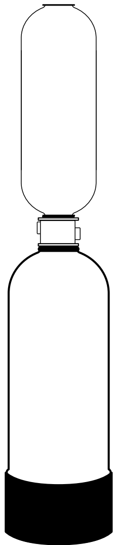
TANQUE DEL ACONDICIONADOR DE AGUA
