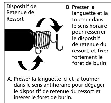
Fig. 1 Dispositif de Retenue de Ressort
