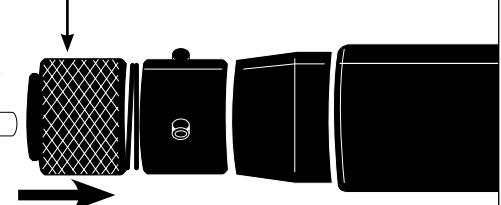
Figura 2 - Funcionamiento del Retenedor de Conexión Rápida
