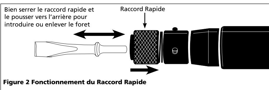
Figure 2 Fonctionnement du Raccord Rapide
