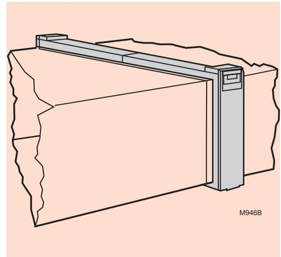
Fig. 8. Deux épurateurs d'air électronique ou plus utilisés dans un système haute capacité.
