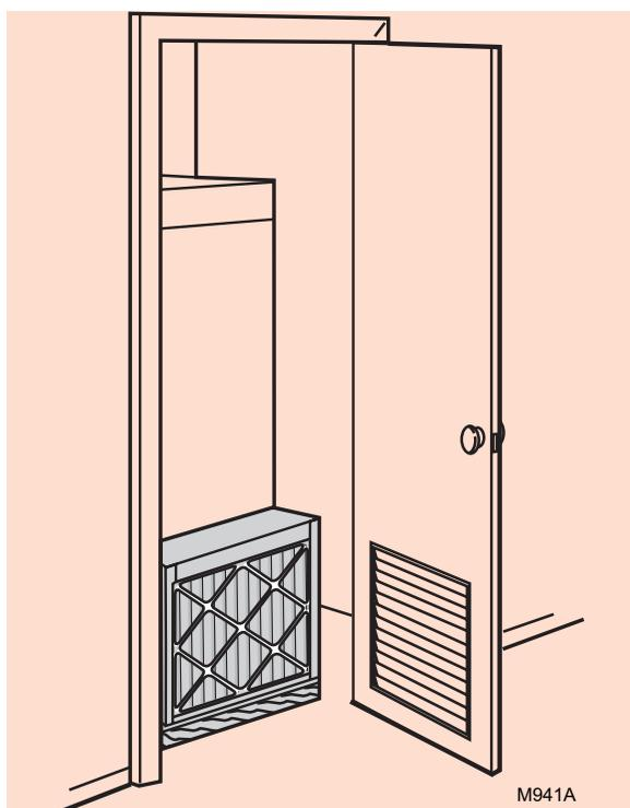
Fig. 3. Chaudière superposée dans un placard. L'épurateur d'air électronique se monte verticalement sur la chaudière entre cette dernière et l'ouverture de l'air de retour à volets de la porte du placard.
